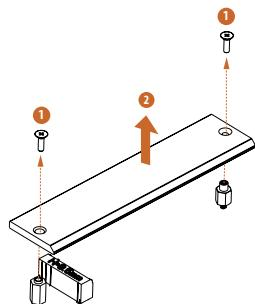
M.2 (NGFF) SSD モジュールを取り付ける前に、ねじを緩めて M.2 ヒートシンクを取り外してください。
