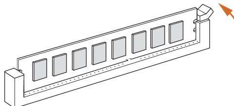
このマザーボードには 4 つの 288 ピン DDR4 (ダブルデータレート 4) DIMM スロットが装備されており、デュアルチャンネルメモリ技術に対応します。
